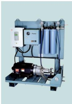
El **módulo de bomba** suministra agua a alta presión para las boquillas patentadas, lo cual elimina la necesidad de usar un sistema de aire comprimido. El agua por ósmosis inversa (RO) se suministra al sistema de bomba a 25 a 60 psig (172 a 413 kPa) y sale de las boquillas a 1000 psig (6895 kPa). Las bombas están disponibles en bronce o acero inoxidable, y con o sin controlador de frecuencia variable.
