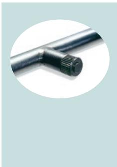
Las **boquillas de alta precisión** suministran gotas de 10 a 40 micrones a través de un orificio de 0,008". Una sola boquilla produce 12 lb/h de agua sin la necesidad de usar aire comprimido. Las boquillas de Nortec, con estructura de acero inoxidable duradero y montadas de fábrica en distribuidores, se integran fácilmente a cualquier proyecto.
